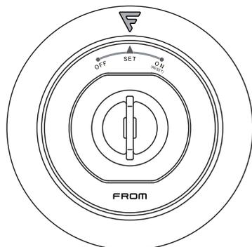
投入口にフタスイッチを挿入してください。
