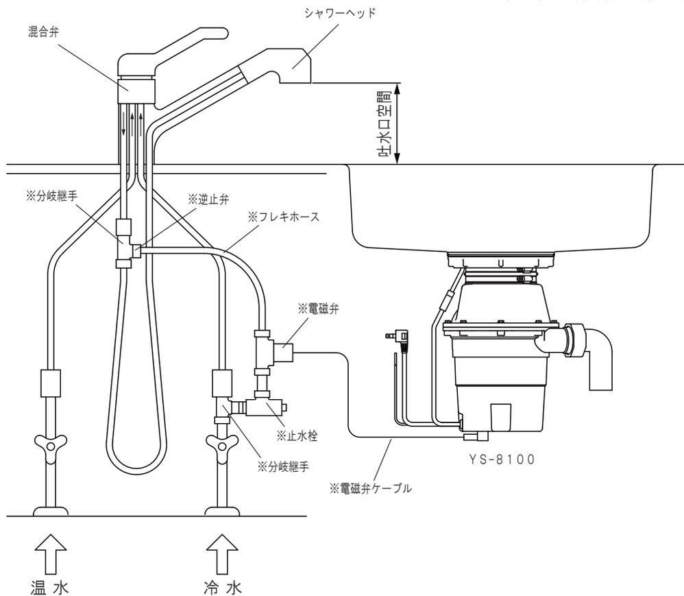
自動給水型ディスポーザとシャワー引出し型混合水栓の設置例
